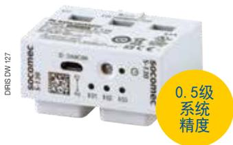
DIRIS Digiware S结合了电力监控设备和电流互感器，以提供终极的一体化解决方案。DIRIS Digiware S模块具有3个集成式电流互感器，可以测量三相或单相回路，最高可达63 A，精度为0.5级。
