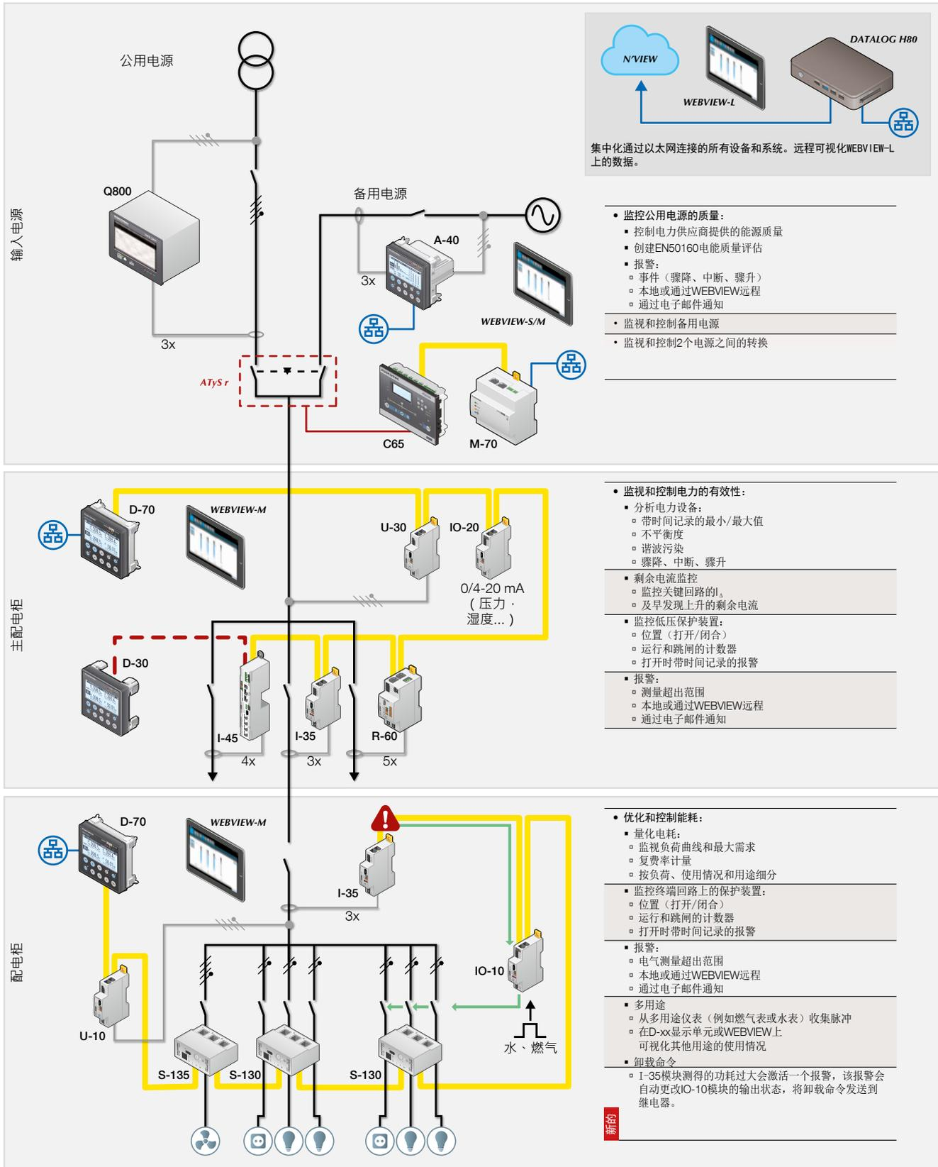
集中化通过以太网连接的所有设备和系统。远程可视化WEBVIEW-L上的数据。
