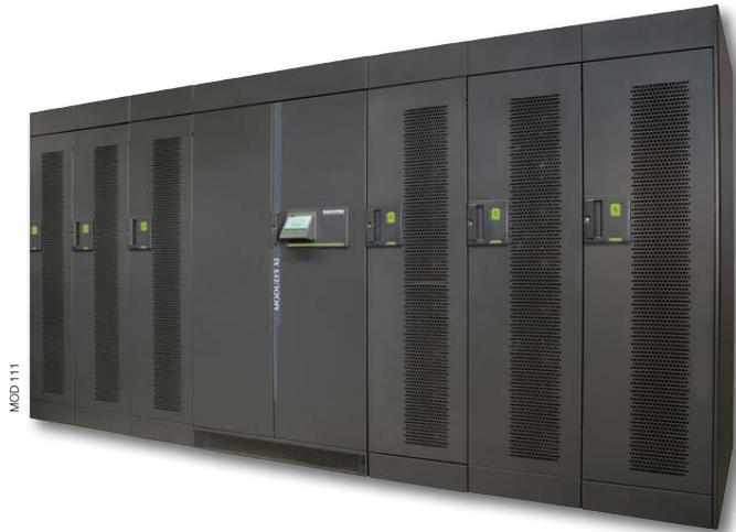
MODULYS XL是基于200 kW功率模块的模块化UPS。单机功率可以扩展到1200 kW，并且系统可以并联多达4台机器。
